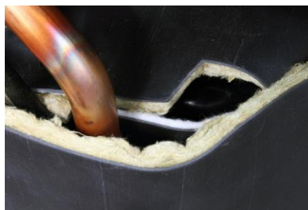
Obrázek 19: Tepelná a zvuková izolace kompresoru (řez)
