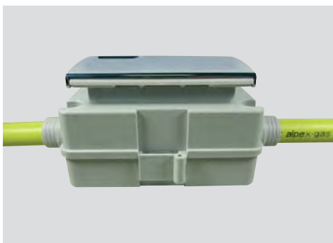
Boční pohled na podomítkový ventil s dvířky. Po horní hranu víka je nutno montážní krabici zapustit do stavební konstrukce, následně se pomocí dvou vrutů připevní ozdobný kryt s nápisem GAS, který po otevření umožňuje přístup k ovládací hlavici kulového plynového ventilu.
