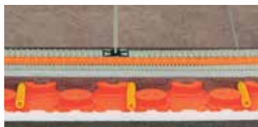
Konstrukční skladba se Schlüter®-BEKOTEC-EN/P resp. -EN/PF
